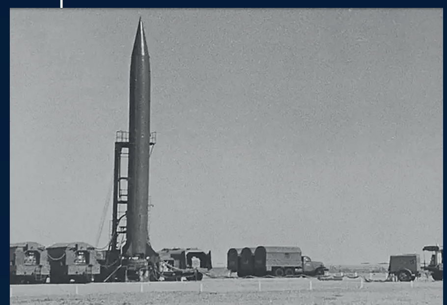
Modifikovaná verze sovětské balistické rakety R-5A byla v šedesátých letech 20. století používána k vynášení užitečných zatížení, která se mohla oddělit od nosiče a vrátit se zpět na Zemi pomocí padáku.
